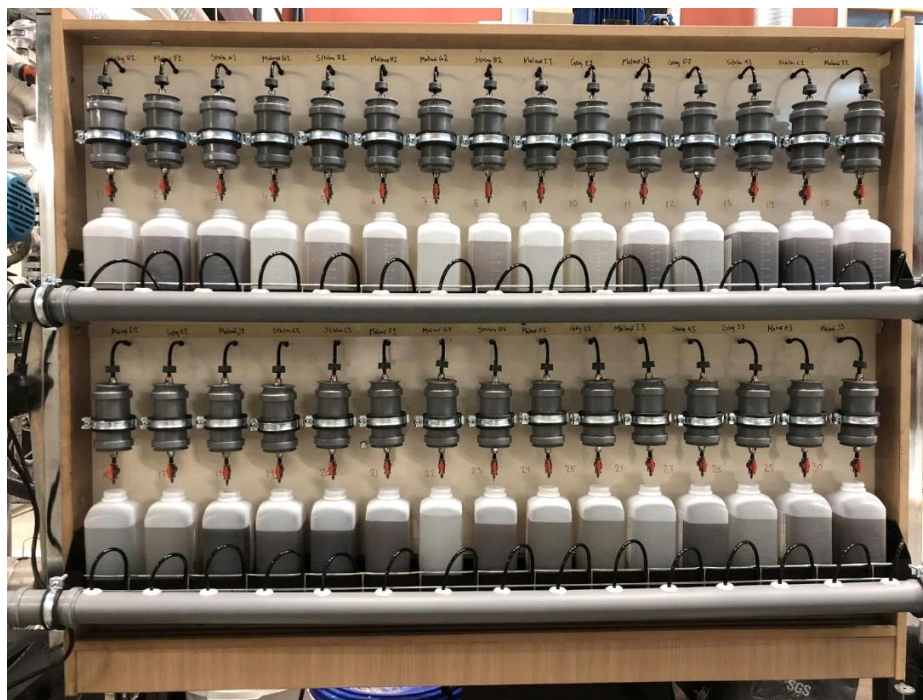
FIGUR 6 FÖRSTA VATTNET SOM PASSERADE BEHANDLINGARNA UNDER LAKTEST 1. "FIRST FLUSH" TENDERAR ATT GENERERA MÖRKARE VATTEN DÅ INNEHÅLLET AV LÖST ORGANISKT KOL OFTA ÄR HÖGRE I BÖRJAN. VARIATIONER BEROR VIDARE AV BEHANDLINGENS INNEHÅLL OCH SUBSTRATETS EGENSKAPER.
