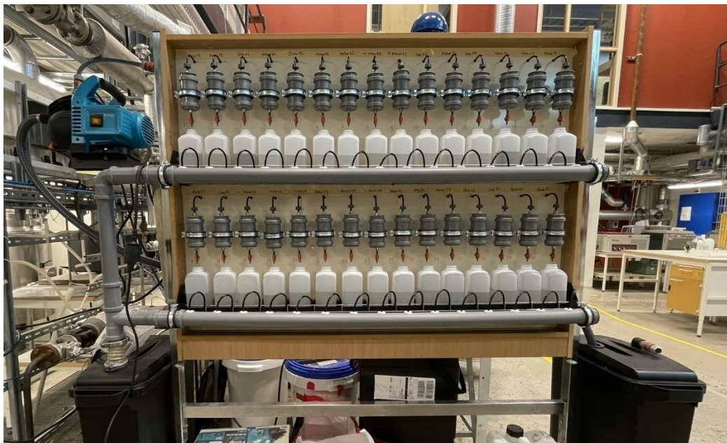
FIGUR 5 FÖRSÖKSUPPSÄTTNINGEN FÖR LAKTESTET.
