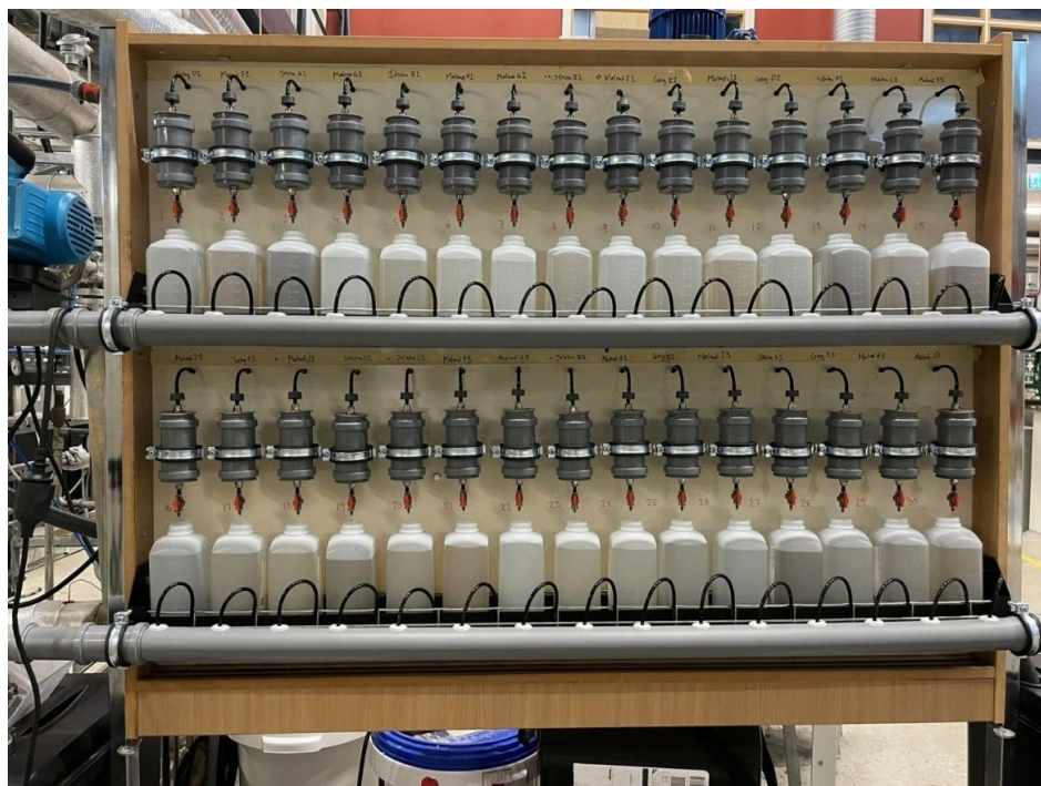
FIGUR 8 FÖRSTA LAKVATTNET SOM PASSERAR BEHANDLINGARNA I LAKTEST 3.
