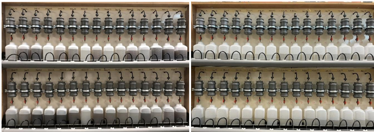
FIGUR 9 TILL VÄNSTER: DET FÖRSTA CA 1 LITERN VATTEN SOM PASSERADE SUBSTRATET I LAKTEST 1. TILL HÖGER: DET SISTA CA 0,6 LITERN VATTEN FRÅN LAKTEST 3, EFTER ATT TOTALT CA 4,8 LITER PASSERAT VARDERA SUBSTRAT. VATTNET TILL HÖGER ÄR TYDLIGT KLARARE.
