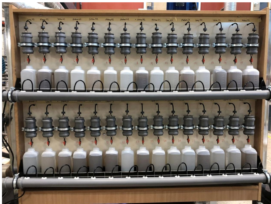
FIGUR 7 FÖRSTA LAKVATTNET SOM PASSERAR BEHANDLINGARNA I LAKTEST 2.
